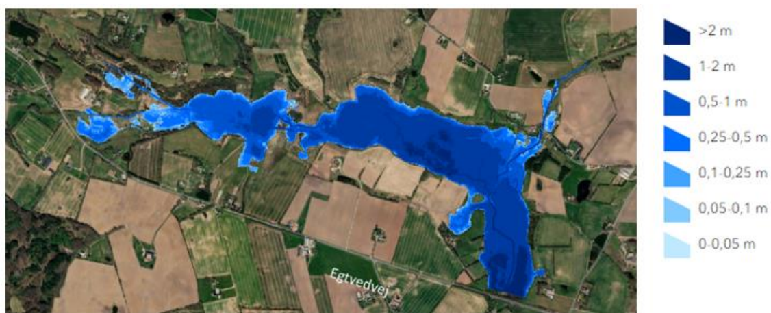
Bølling Bæk magasinet med maksimal udbredelse svarende til en 100 års hændelse i 2075 klimaet med aktiveret sluse. Signaturforklaringen viser vanddybder i magasinet.
